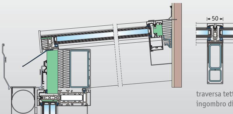
traversa tetto con ingombro di 5 cm
