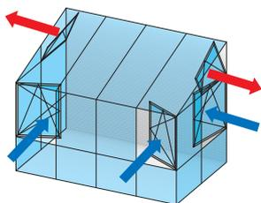
passaggio dell'aria attraverso finestre e porte-finestre ad anta/ribalta, a ribalta
