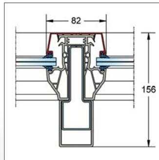
traverse del tetto con rinforzo in acciaio
