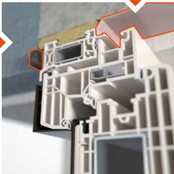
I nastri ad espansione si dilatano nelle fughe assicurando una sigillatura dell'attacco a muro resistente alle intemperie senza l'impiego di schiume chimiche. Grazie ai nastri ad espansione e alle guaine sigillanti il serramento e la muratura sono al riparo dall'acqua e protette dai danni.
